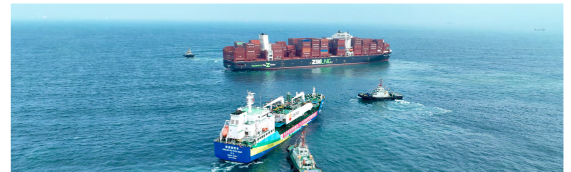
香港长洲南锚地“船对船”海上 LNG 加注作业
